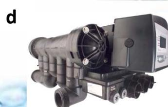
Los suavizadores tienen la finalidad de remover dureza del agua. Esto quiere decir que el calcio y magnesio, que producen la dureza, serán removidos casi por completo del agua que se va a tratar. El suavizador hace su función a través de resinas de intercambio iónico de tipo catiónicas que sustituyen el calcio y magnesio del agua por sodio. Para esto las resinas requieren una regeneración con sal (industrial) para recuperar su capacidad de intercambio.
