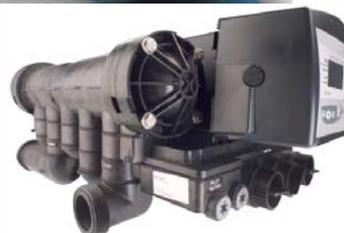
Los suavizadores tienen la finalidad de remover dureza del agua. Esto quiere decir que el calcio y magnesio, que producen la dureza, serán removidos casi por completo del agua que se va a tratar. El suavizador hace su función a través de resinas de intercambio iónico de tipo catiónicas que sustituyen el calcio y magnesio del agua por sodio. Para esto las resinas requieren una regeneración con sal (industrial) para recuperar su capacidad de intercambio.
