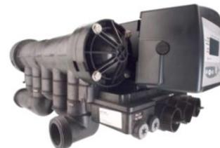
Los suavizadores tienen la finalidad de remover la dureza (agua dura). Esto quiere decir que el calcio y magnesio, que producen la dureza, serán removidos casi por completo del agua que se va a tratar. El ablandamiento de agua se lleva a cabo por medio de resinas de intercambio iónico de tipo catiónicas que sustituyen el calcio y magnesio del agua por sodio. Para esto las resinas requieren una regeneración con sal (industrial o pelet) para recuperar su capacidad de intercambio.
