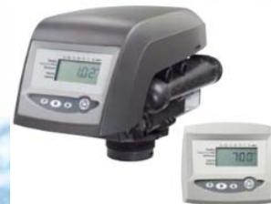
Los suavizadores tienen la finalidad de remover dureza del agua. Esto quiere decir que el calcio y magnesio, que producen la dureza, serán removidos casi por completo del agua que se va a tratar. El suavizador hace su función a través de resinas de intercambio iónico de tipo catiónicas que sustituyen el calcio y magnesio del agua por sodio. Para esto las resinas requieren una regeneración con sal (industrial) para recuperar su capacidad de intercambio.
